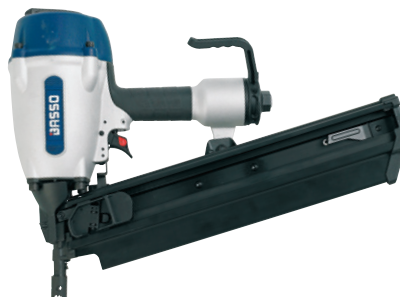
STAVSPIKERPISTOL 17° A17/90-F1 Varenr. 50010608 Nobb. 27186477 Ø 2,80 - 3,80 mm | lengde 50 - 90 mm | vekt 3,1kg.
